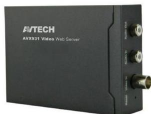
Video Server - Permette la conversione di una telecamera analogica in una telecamera IP - 1CH - Compressione video H.264/mpeg4/jpeg - Risoluzione massima 704x576 - 1 ingresso + 1 uscita Audio - 1 ingresso + 1 uscita allarme - Protocollo RS485 e Pelco-D/P per controllo Speed Dome - Interfaccia di rete 10/100 - 12V (Alimentatore incluso)
